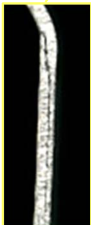
ブランクの圧延方向に 沿って生じた割れ
