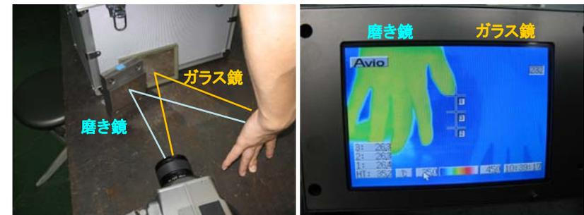
磨き鏡を使った反射像でも温度測定が可能
