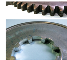
板鍛造製品の切り口 機能面: 歯車, 嵌合部
